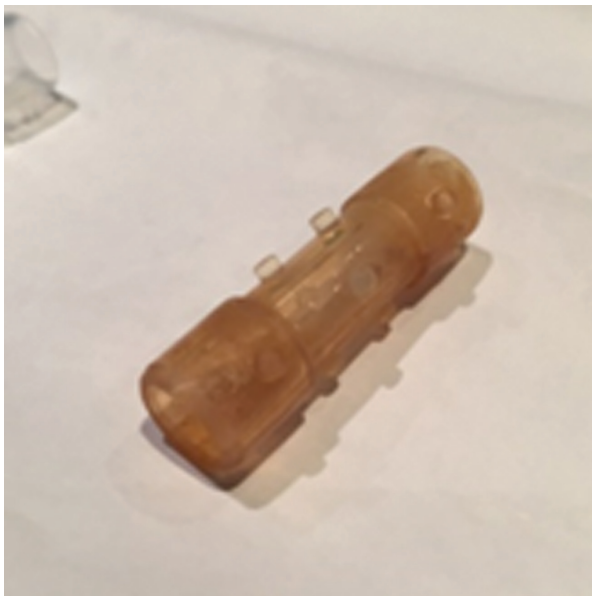
Imagen F. Stent extraído luego de 10 años de permanencia. Se observan cambios de la coloración del elastómero como consecuencia del avance espontáneo del proceso de vulcanización a baja temperatura.
