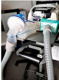
Fuga de 5 mm realizada con aguja de biopsia por punción (fuga calculada a 30-40 l/min a presión de 10 cm H2O)
